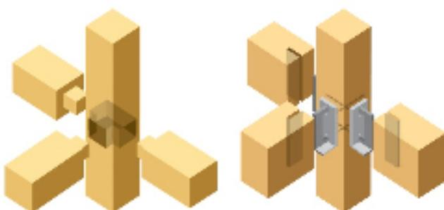
在来軸組工法→「仕口」や「継ぎ手」の加工が必要なため欠損部が多くなります。
